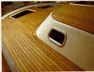
Utan skruvar blir däcket 100% tätt.
