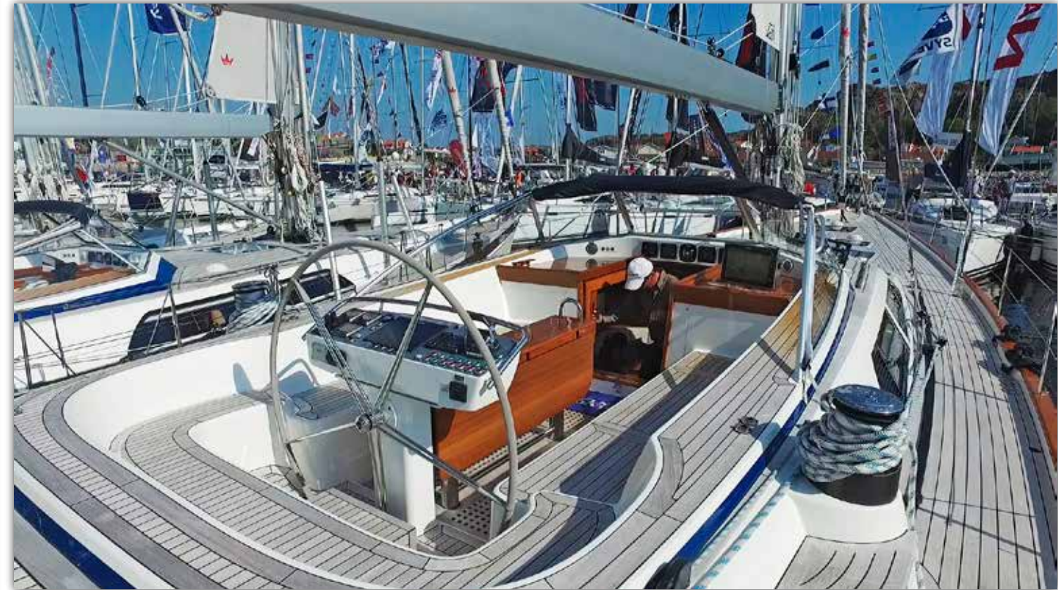
Nya Hallberg-Rassy av större modell, här en HR 64, har så kallad "knappsegling", många funktioner är motoriserade och styrs via knappar, vilket medför att båten trots sin storlek kan seglas av liten besättning.
