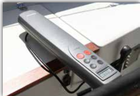
En autopilot drar elström men är väldigt smidig att använda och tar inte mycket plats.
