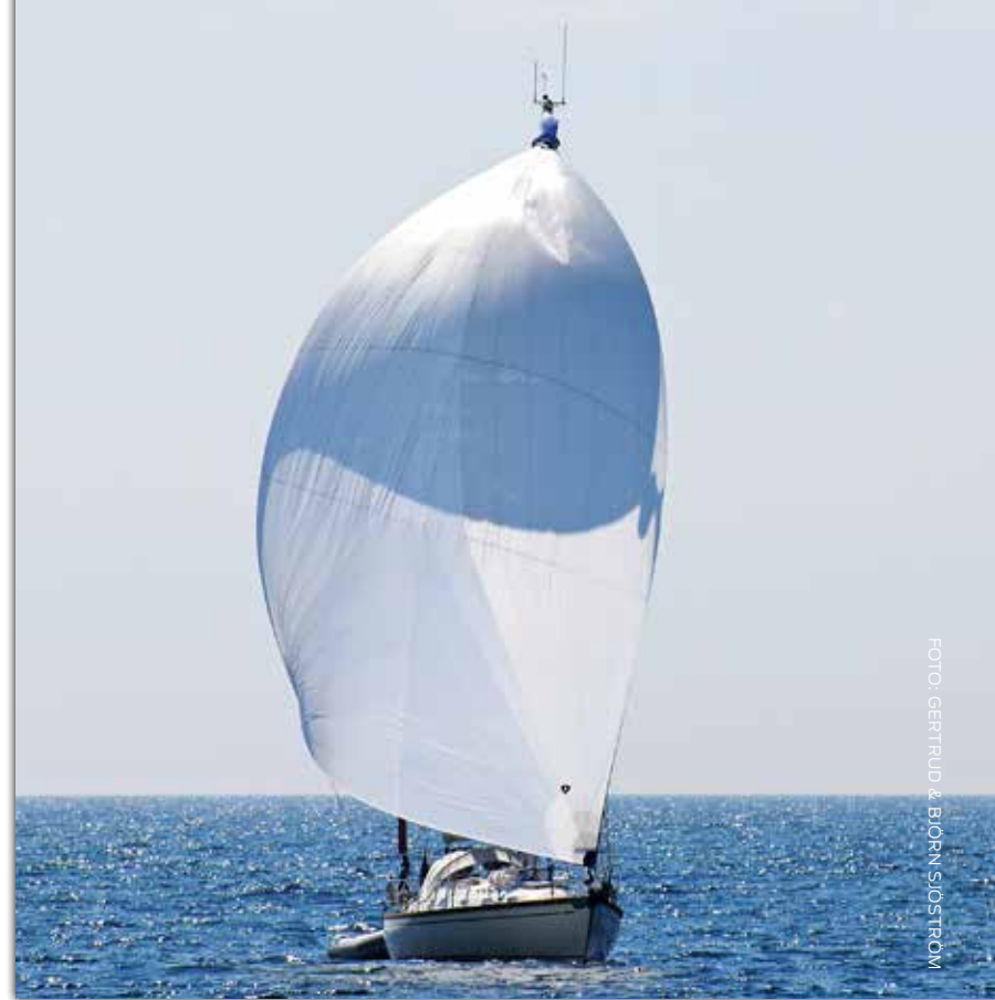
Allegro 33, en klassisk rejäl koster med mastheadrigg, lång köl och djupt skrov, är känd för mjuk gång i jobbig sjö.
