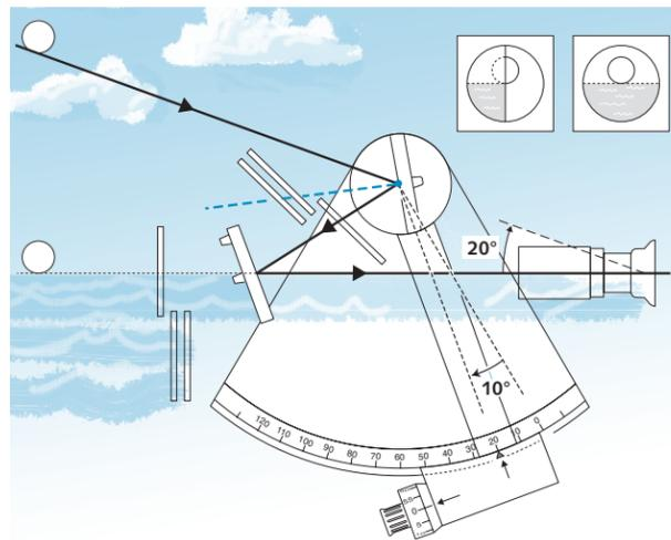
Blendgläser vor die Spiegel klappen, durchs Fernrohr schauen und so viele Blendgläser wieder zurückklappen, bis die Sonne im Spiegel erkennbar wird. Dann die Alhidade sachte vor und zurück schieben, bis die Sonne im Spiegel den Horizont berührt. Zur Kontrolle eine seitliche Pendelbewegung mit dem Sextanten ausführen. In der Vertikalen muss die Sonne die tiefste Position einnehmen.
