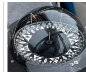
Eine Ablenkungstabelle gehört auf jedes Schiff. Die Werte lassen sich etwa mithilfe des zentralen Dorns der Kompassrose ermitteln
