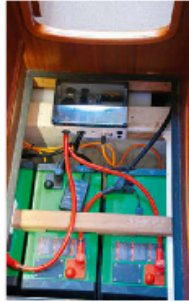
Gelöschter Lithiumbrand auf einem E-Motorboot. Die gesamte Elektrik musste erneuert und das Boot gereinigt werden
