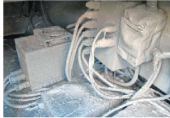
Gelöschter Lithiumbrand auf einem E-Motorboot. Die gesamte Elektrik musste erneuert und das Boot gereinigt werden
