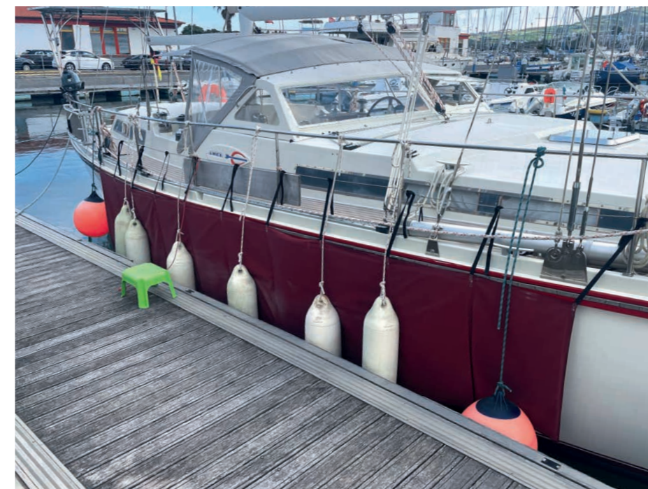
Eine Fenderschürze hilft den Rumpf, vor Abnutzungen durch die Fender zu schützen. Die Fender hängen in verschiedenen Höhen und werden zu den Schiffsenden hin dicker
