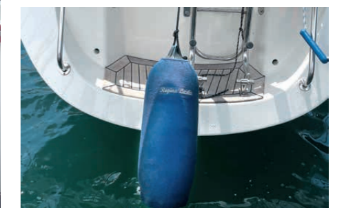
Wird mit dem Heck angelegt, kann ein Fender bei auflandigem Sturm Schaden abwenden
