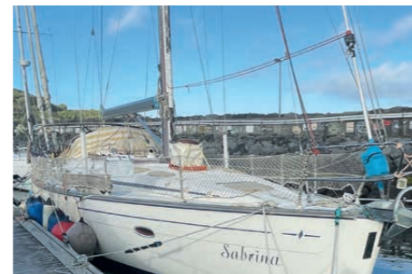
Das Rollvorsegel wurde geborgen, die Trommel abgedeckt und das Vorstag gespannt
