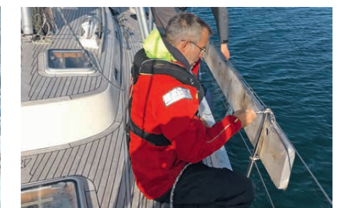
Ein Fenderbrett ermöglicht es, das Boot an rauen Spuntwänden oder Pollern abzufendern
