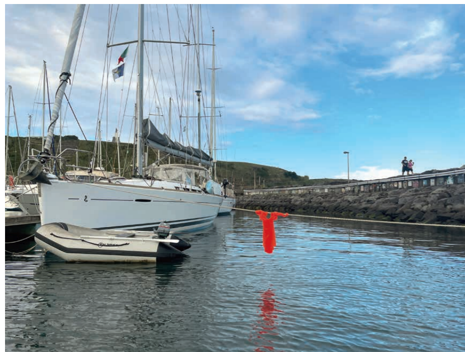
Eine lange Leine nach Luv soll die Yacht bei aufkommendem Wind vom Steg abhalten. Damit sie von anderen Skippers nicht übersehen werden kann, wurde sie deutlich gekennzeichnet
