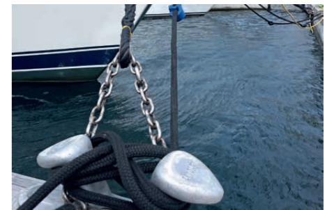
Eine Kette auf der Klampe schont den Festmacher und ist auch nachträglich zu montieren
