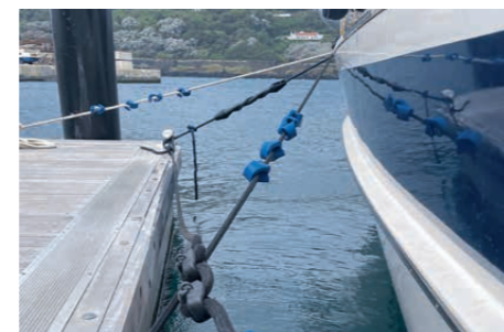
Nachträglich montierte Ruckdämpfer und Lastenverteilung durch verschiedene Leinen
