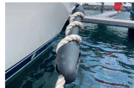
Bei diesen Ruckdämpfer ist der Festmacher durch die Konstruktion gegen Bruch sicher
