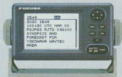
△ En Navtex tar kontinuerligt emot väderprognoser och navigationsvarningar som lagras i ett minne och som sedan kan läsas när det passar.
