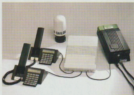
△ Iridium kan kopplas till en vanlig telefonväxel med flera standard-telefoner.
