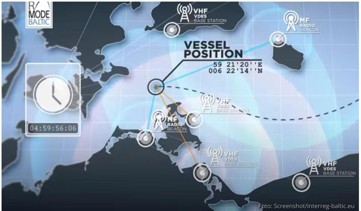
Das Range-Mode genannte terrestrische Navigationssystem soll die Sender des DGPS-Systems und UKW-Seefunksender nutzen, es kann Positionsgenauigkeiten zwischen 10 und 60 Metern liefern
