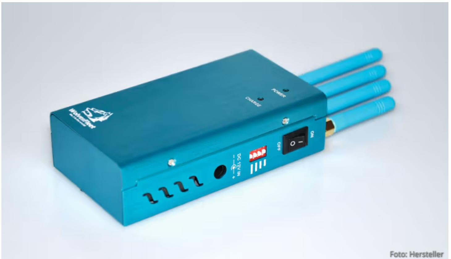
Ziviler GPS-Jammer für wenige hundert Euro, die Reichweite ist begrenzt. Trotzdem können die Geräte Fahrzeugtracking, Navigation und Geldautomaten außer Gefecht setzen
